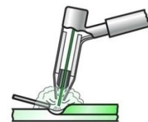
Gas-tungsten arc welding
