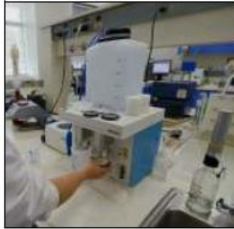
Resim 3.3: Glutomatik cihazında gluten tayini
