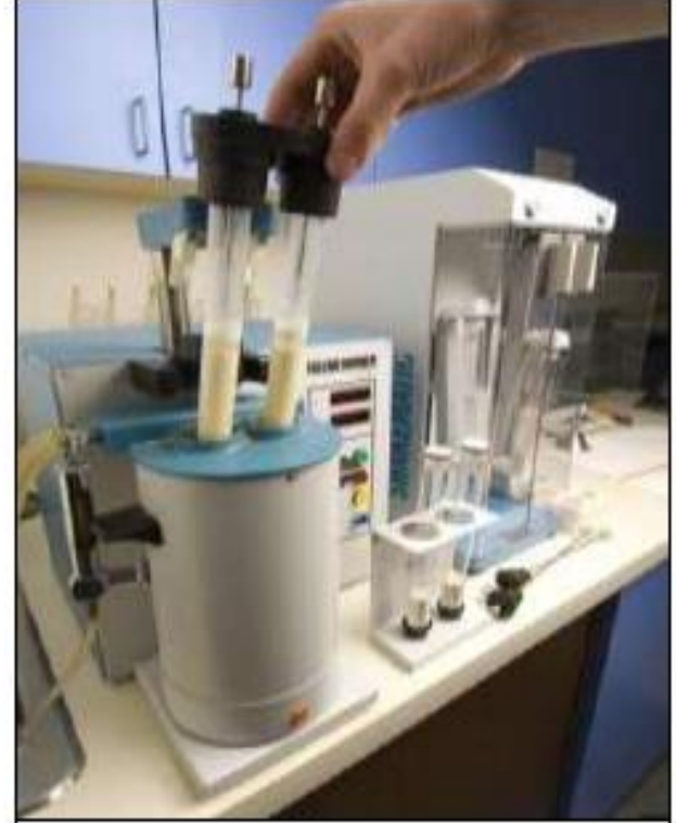
Resim 3.10: Vizkometre karıştırıcısını tüpe yerleştirme Resim 3.11:Tüpleri cihaza yerleştirme
