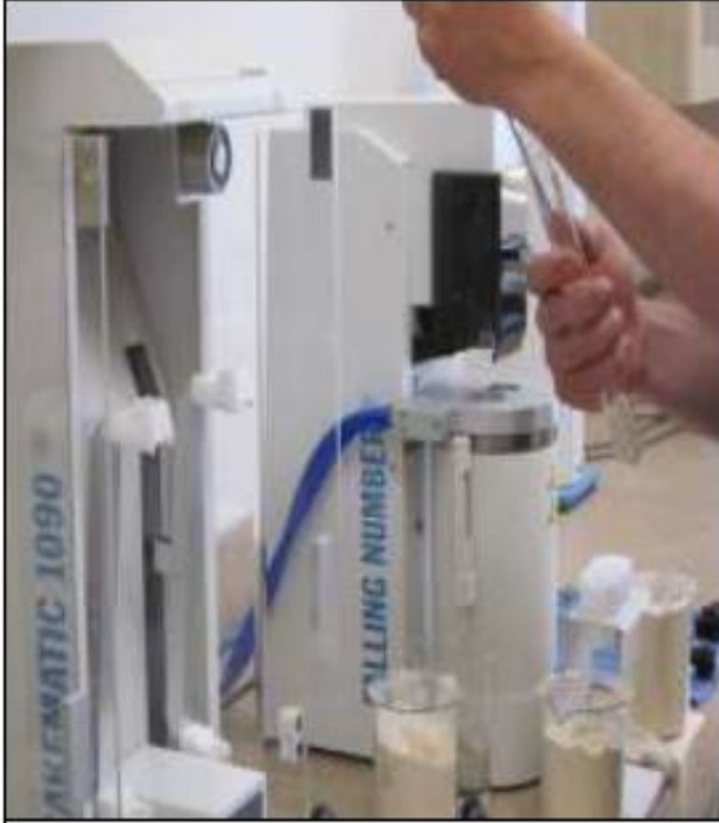
Resim 3.10: Vizkometre karıştırıcısını tüpe yerleştirme Resim 3.11:Tüpleri cihaza yerleştirme
