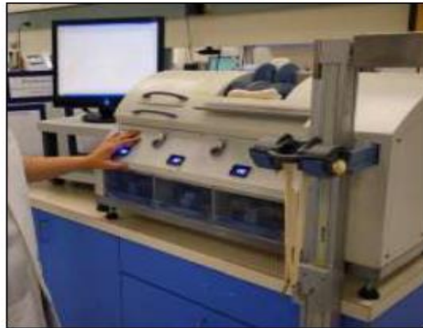
Resim 4.6: Hamurun kanca ile gerilmesi
