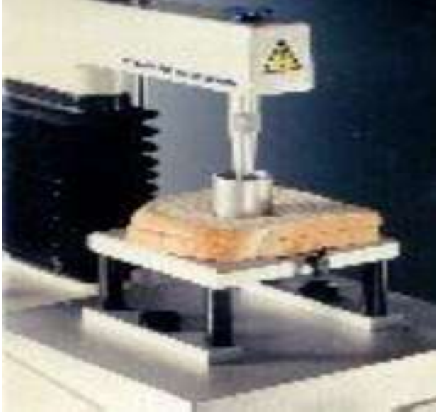
Resim 1.9: Penetrometre cihazında ekmek içi sertliğinin ölçümü
