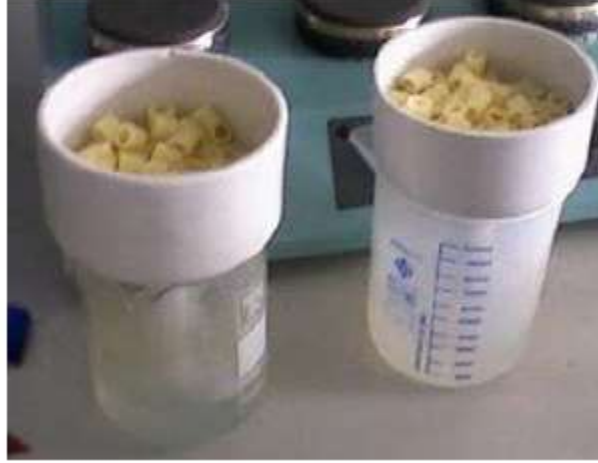
Resim 2.4: Makarna numunelerinin bühner hunisinde süzülmesi
