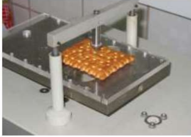
Resim 3.7: Strüktografla bisküvinin kırılması
